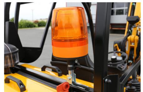
Die optionale Rundumleuchte wird in geschützter Position untergebracht.
