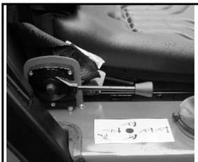
Facultativement, il est possible d'équiper la chargeuse avec une manette d'accélérateur, qui permet de régler la puissance du moteur sans la pédale.
