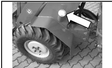
La tubulure du réservoir de carburant Diesel se trouve à gauche sur le chariot avant.
