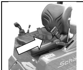
Le siège du conducteur est équipé d'une ceinture de sécurité (ceinture abdominale).
