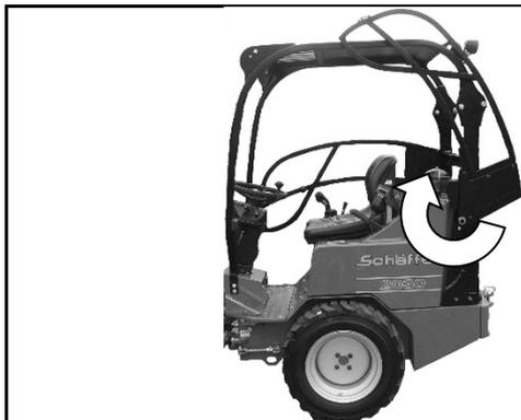
La porte peut être relevée pour monter et descendre sur la machine. Il est ainsi possible de l'ouvrir même dans un passage étroit.
