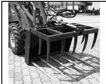
Les pinces à fumier et à désilage constituent un accessoire destiné à prélever et à transporter du fumier, de l'ensilage en vrac et de la fourrure crue en vrac.
