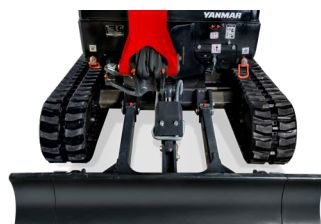
Châssis élargi : 1 380 mm
