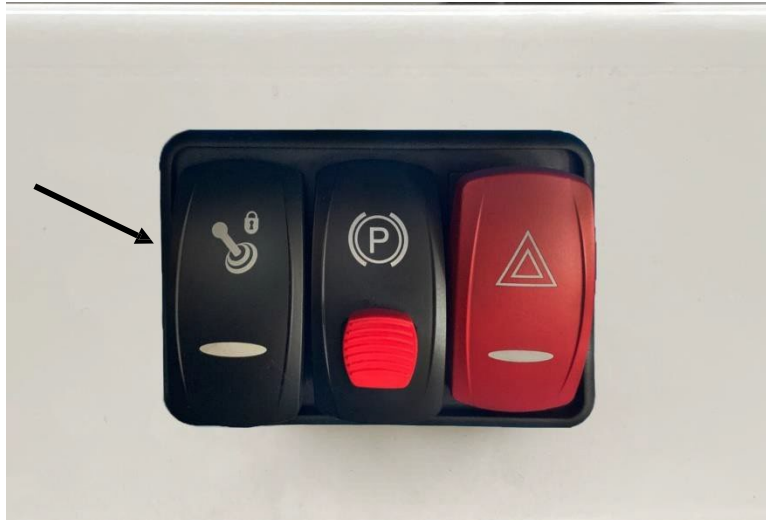
Figure 23. Verrouillage de la fonctionnalité du joystick
