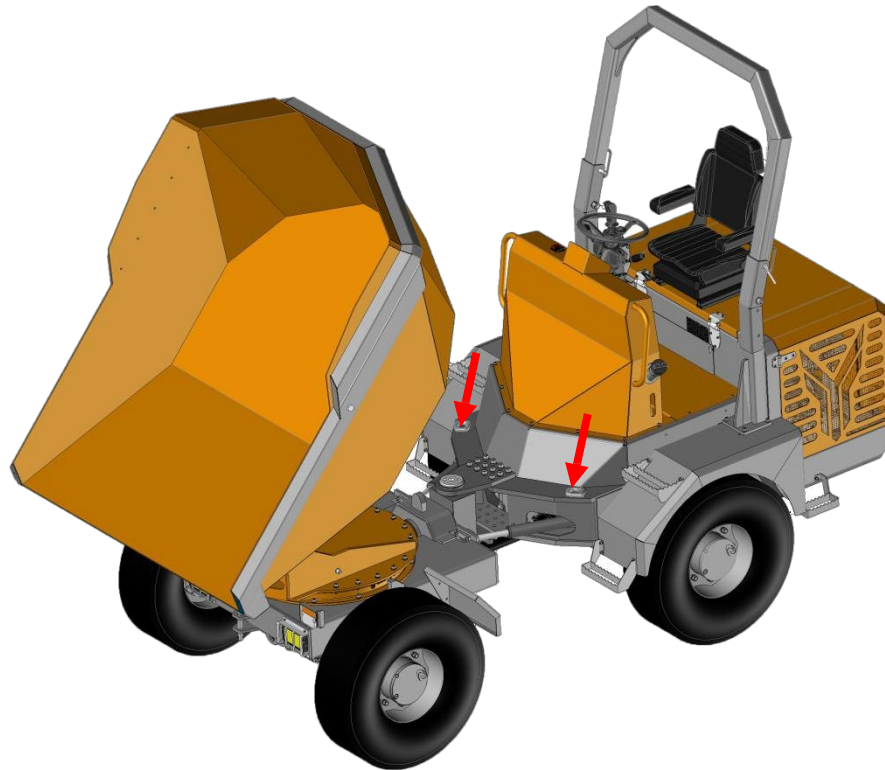
Figure 25. Crochets pour le levage du véhicule
