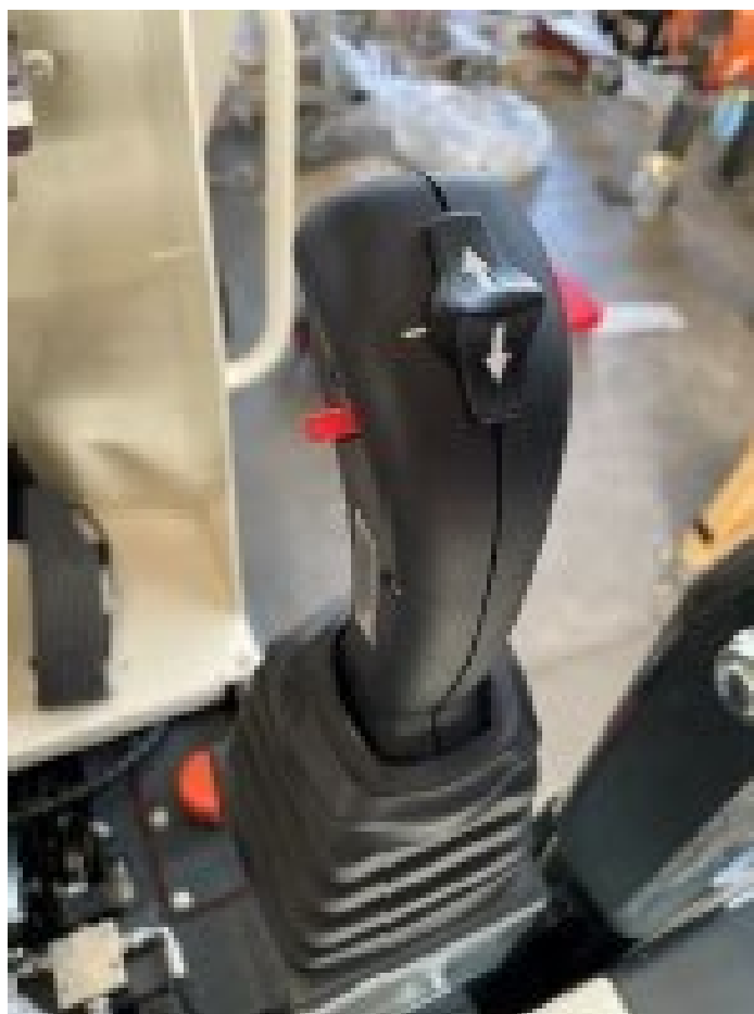
Figure 13. Levier de vitesses Tableau 4 – Fonctions de changement de vitesse
