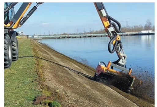
bema 25 mit Wildkrautbürste, Anbau Bagger (Sonderbau)
