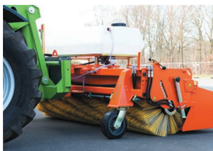
Stabile Super-Elastiklaufräder Ø 300 x 90 mm, Anbau Teleskopklader
