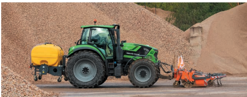
bema 35 Dual PowerMaster ausgestattet mit Schmutzsammelwanne Dual inkl. Aufkratzvorrichtung, Hochdruckspülanlage, 2000 l Wassertank im Heck und zertifiziertem Kamerasystem
