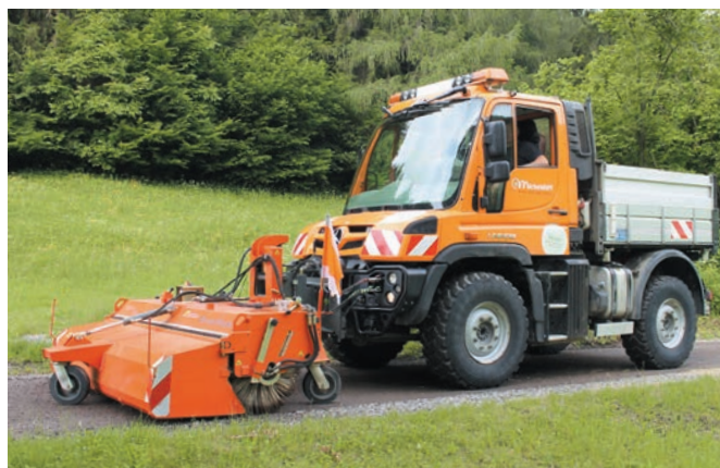
bema 35 Dual PowerMaster im kommunalen Einsatz, Unimog-Anbau
