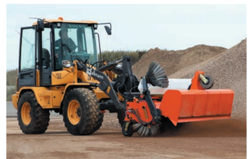
bema 35 Dual PowerMaster mit Wassersprüheinrichtung und Seitenkehrbesen (Freikehren)
