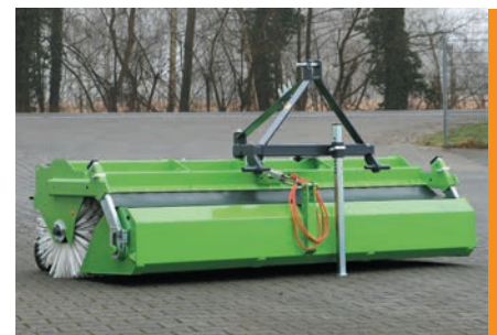
bema 20 AgrarLine: Kehrwalze Ø 520 mm (PPN), Arbeitsbreite 2300 mm, Seilzug, Schlepper-Heck
