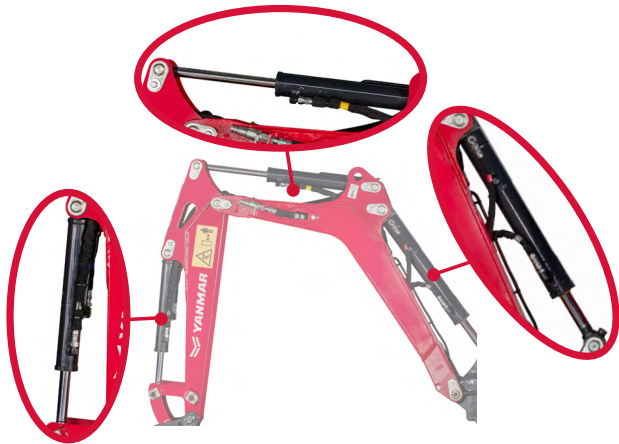
Cilindri montati sopra il braccio
