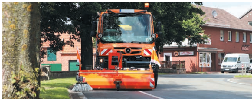
bema 30 Dual PowerMaster am Unimog mit Seitenkehrbesen und hydraulischer Seitenverschiebung (rechts/links je 500 mm)
