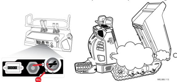
fig. 31 – Contrôle des bougies
