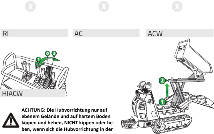
Abb. 15 – Steuerhebel des drehbaren Greifers (oben) „Hi-Tip“ Hubvorrichtung (unten)
