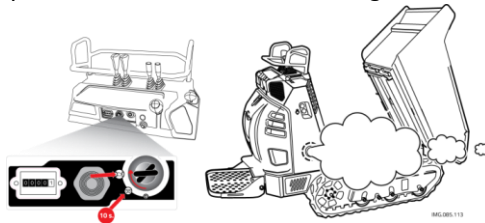
Abb. 31 – Überprüfung der Glühkerzen
