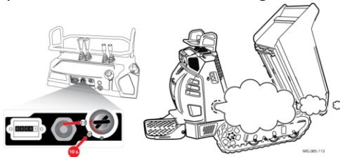
Abb. 31 – Überprüfung der Glühkerzen
