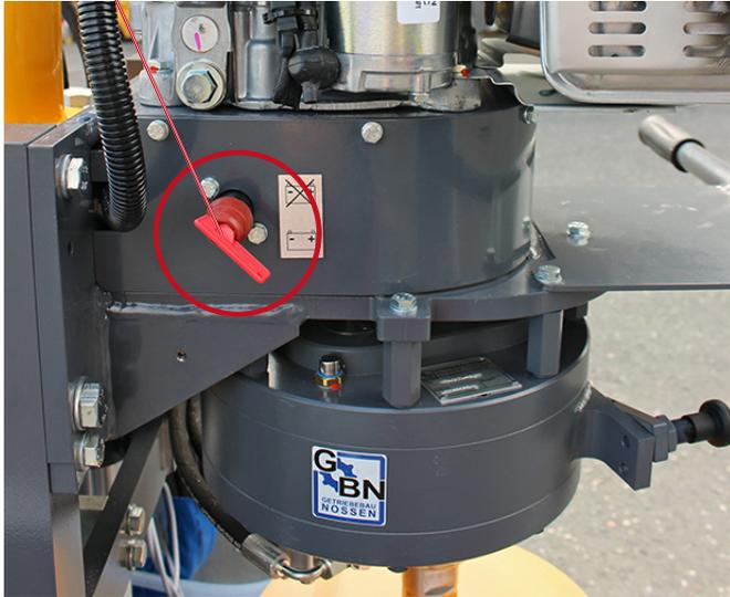
Die Starteinrichtung befindet sich am Not-Aus-Schalter bzw. auf dem Bedienpult.
