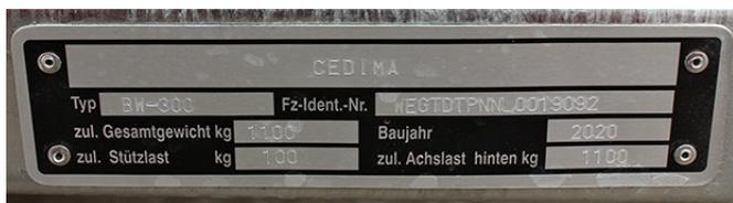
Fahrgestellschild der Maschine
