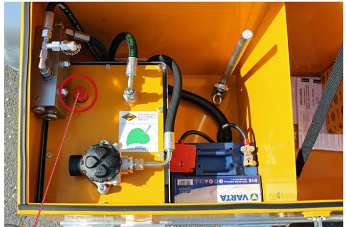
Ölmesstab zur Hydraulikölstandskontrolle
