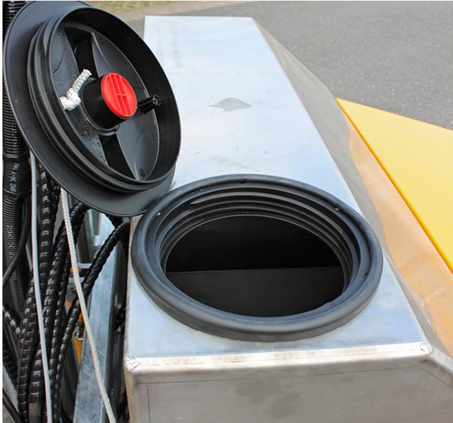
Wassereinfüllöffnung am Wassertank
