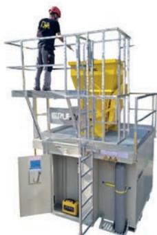
6 m<sup>3</sup>, ideal für mittelgrosse Baustellen im Hochbau und Tiefbau. Vielseitig einsetzbar zum Waschen von Baugeräten sowie Absetzen und Neutralisieren von Baustellenabwasser mit Automatik.
