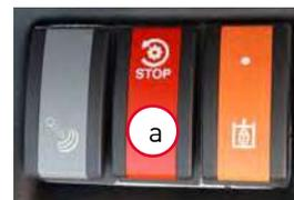
L'interrupteur « a » (interrupteur d'arrêt d'urgence du régulateur de vitesse) doit être activé pour que le régulateur de vitesse fonctionne.
