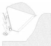
Soulever légèrement le godet et le basculer complètement en position relevé. Conduire avec le godet abaissé jusqu'au lieu de déchargement et lever le godet seulement à ce moment-là pour le décharger.
