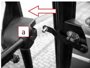
Les portes de la cabine doivent rester fermées pendant le travail. En cas de besoin, la porte peut rester entre-ouverte. A cet effet, rabattre le levier indiqué sur la figure ci-contre vers l'extérieur et l'encliquer dans la serrure de la porte (a).
