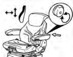
Tourner la poignée (flèche) indifféremment vers la gauche ou vers la droite pour régler le soutien lombaire en hauteur et en profondeur.
