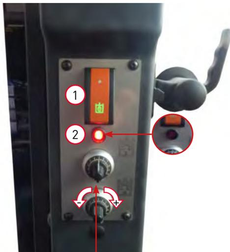
Le débit maximal peut être réglé progressivement de 5 % à 100 % par potentiomètre (3+4), **individuellement pour chaque coupleur auxiliaire**. Ce réglage influence aussi bien sur la commande par manette du joystick (5) que sur le verrouillage électrique (1).
