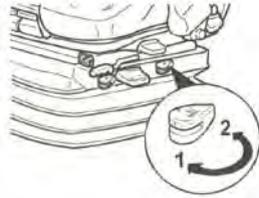
L'amortissement du siège peut être adapté à la configuration de la chaussée ou du terrain. Le confort d'assise est donc réglable en fonction des besoins individuels.
