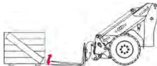
Pour des travaux de chargement, le bras télescopique doit toujours être amené sur le point le plus bas possible.
