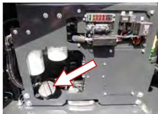
La tubulure du réservoir de gasoil est située du côté droit du chariot arrière sous le capot moteur.
