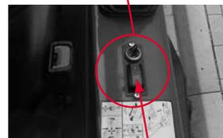
Interrupteur d'arrêt d'urgence du régulateur de vitesse
