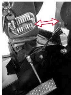
En option, la chargeuse peut être équipée d'un levier d'accélérateur à main. Cela permet de régler la puissance du moteur indépendamment de la pédale de commande.
