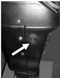
Un vibreur sonore d'alarme se situe à l'avant de la console volant. Celui-ci émet un signal en cas de surchauffe du moteur.
