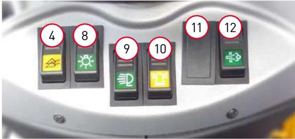
4. Interrupteur « *Déverrouillage de l'outil* »
