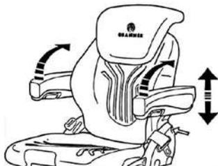
Die Armlehnen können bei Bedarf nach hinten geklappt und in der Höhe individuell angepasst werden.
