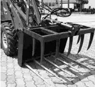
Das Krokodilgebiss ist ein Anbaugerät zum Entnehmen und Befördern von Dung, loser Silage, losem Stroh und Raufutter.
