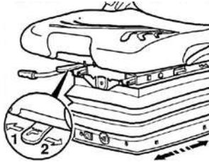
Durch die Längshorizontalfederung können Stoßbelastungen in Fahrtrichtung (z.B. bei höheren Geschwindigkeiten oder in schwierigem Gelände) durch den Fahrersitz besser abgefangen werden.
