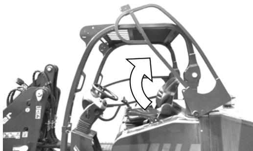
Zum Ein- und Aussteigen wird die Tür nach oben geklappt. So kann sie auch in engen Durchgängen geöffnet werden.
