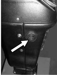
An der Vorderseite des Lenkturms befindet sich ein Warnsummer. Dieser ertönt bei Überhitzung des Motors.
