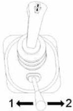
Um den hydraulischen Zusatzkreislauf drucklos zu machen, ist wie folgt zu verfahren:
