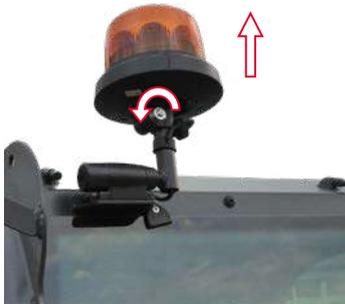
Die Rundumkennleuchte ist abnehmbar. Dazu die Sechskantmutter lösen und Leuchte nach oben abziehen.
