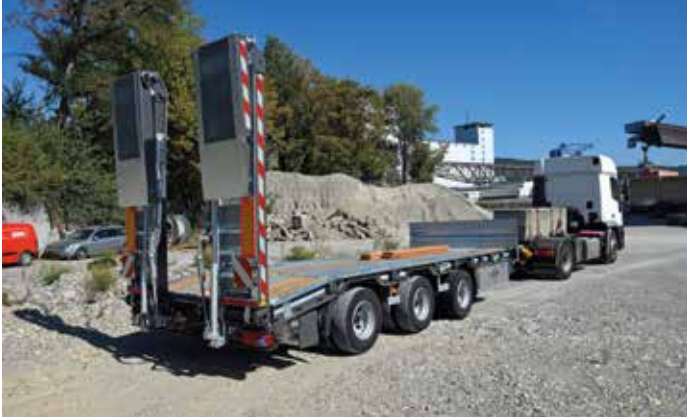
Blöchlinger Paul Agro, Benken Typ TDUE 280 ZSR: Eines der Highlights der letzten Jahre. Mit Lift- und zwei Lenkachsen, grosse 4.20 m lange Faltrampen für einen flachen Auffahrwinkel.
