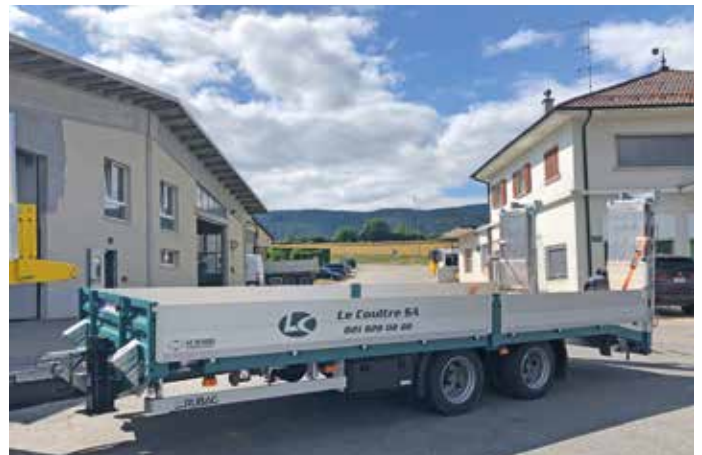
Le Coultre SA, Gimel Typ TUE 134 ZSR: 15 t Gesamtgewicht, Brücke 6,25 m mit Heckschräge und Container-Verriegelungen.
