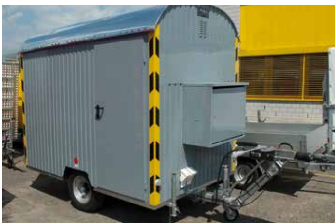
Höhenverstellbare Deichsel und Gasheizung auf Kundenwunsch
