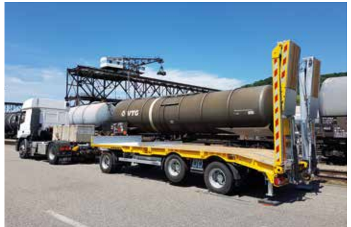
Leonhard Weiss, Regensdorf Typ DTPA 300 ZSR: Dieser 3-Achs-Drehschemelanhängler wird für den Transport schwerer Maschinen und Container eingesetzt.
