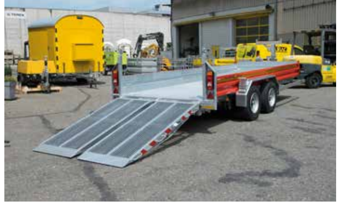
S. Facchinetti SA, 2009 Neuchâtel Typ MTT 1300-80: Tandem-Tieflader für den Maschinentransport. Chassis-Verbreiterung auf 2005 mm, zahlreiche Zurrösen, Queranschlag, EBS-Bremsanlage, Spezialrampen 930 mm breit mit Gitterrost.
