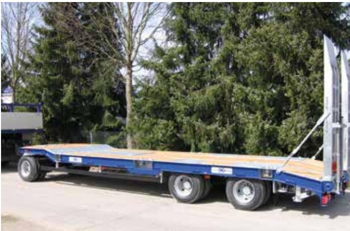
Werkbild vom Typ DBTAG: 3-achsiger Drehschemelanhängler für den Transport schwerer Baumaschinen. Grosses integriertes Staufach für Steckungen im Brückenboden.
