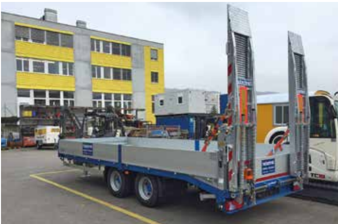
Hubschmid Logistik, Nesselbach Typ TUE 160 ZSR: Brücke verlängert auf 6,25 m und heckseitig angeschrägt zur Verringerung des Auffahrwinkels. Alu-Bordwände, Luftfederung, Container-Verriegelung u.v.m.
