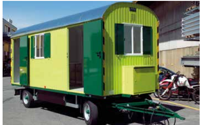
Käppeli Strassen- und Tiefbau, Seewen Typ AZ600: 6 m Länge, 6 t GG, Lattenkasten auf ganzer Länge, Gasheizung und Gerätekiste
