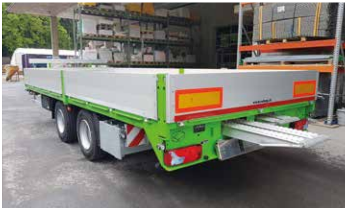
Häller Bau AG, Sempach Typ TUE190ZAR mit Einschub-Rampen, Stapler-Rammschutzleisten und viele weitere Extras wie z.B. zahlreiche Rungen-Kassetten und Zurrmöglichkeiten.
