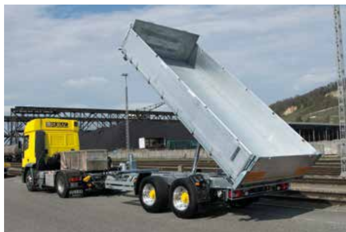
André Züger, Altendorf Typ DK 190 AR: Dreiseiten-Kipphanhänger mit 19 t GG. Brücke aus 5 mm HARDOX aus einem Stück, Schnellläuferachsen, Alu-Bordwände, Rampen, Luftfederung und Spezialstirnwand.
