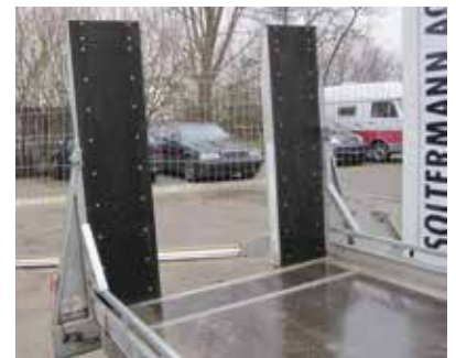
Sicherheit beim Walzentransport: Rampen auf Wunsch mit rutschfestem Belag
