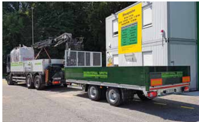
Baumaterial Späth, Riehen Typ LTP 160 Z: Gesamtgewicht 17 t, u.a. mit Alu-Dielenboden und Stirnwandgitter. In Kundenlackierung.
