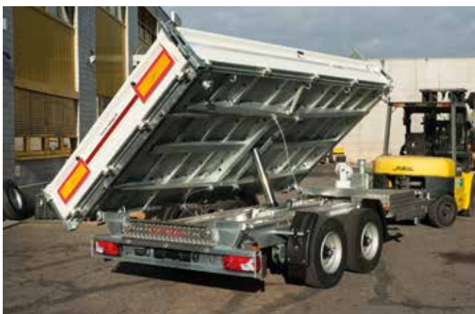
HP Tschirren Bau AG, Buchs Typ DK 105 AR: Tandem-Dreiseitenkipper u.a. mit elektro-hydraulischer Pumpe, Rampen und Stirnbockwand
