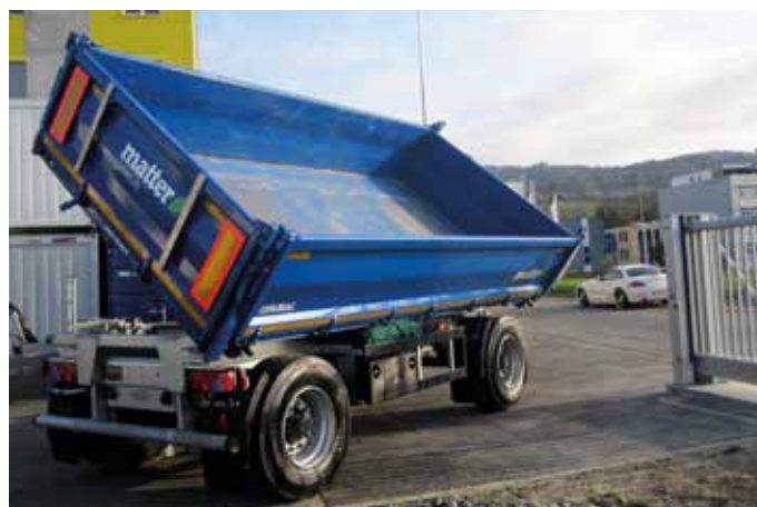
Matter, Buchs Typ ZDK180: Brückenboden und Bordwände aus speziellem HARDOX-Stahl. Wird für Steintransporte eingesetzt.
