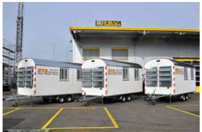
ETS Installationen, Urdorf Typ AT500/EB: Diese Bauwagen mit Polier- und Mannschaftsabteil sind mit optionalen Treppen ausgestattet
