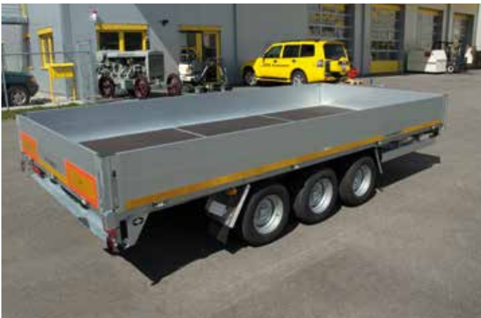
Darnutzer, Sils im Domleschg Typ UET 574520: 3-Achs Pritschenanhänger für den Transport von Stromerzeugern und Baugeräten
