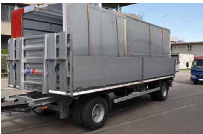
Norline, Glattbrugg Typ ZTA 180 Z: Brückenboden aus HARDOX-Stahl. Halterung für 8 Steckungen an Stirnwand aussen.
