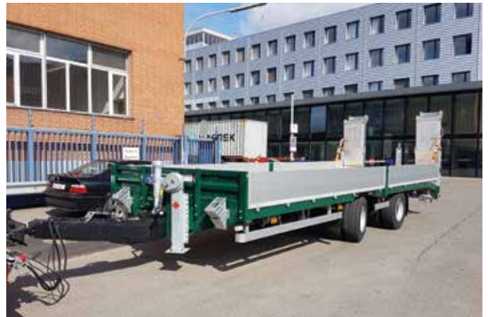
Denogent SA, Lausanne Typ TUE 210 ZSR: Ausgestattet mit einer Lenkachse. Auch dieser Tandem-Tieflader hat eine Heckschräge. Die 7,5 m lange Brücke wurde auf 880 mm Höhe reduziert.
