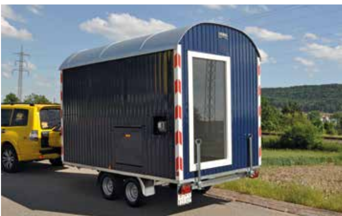
Evergreen Garten GmbH, Henggart Typ AT350/EW: Spezialausführung mit grossem Heckfenster und Gasinstallation
