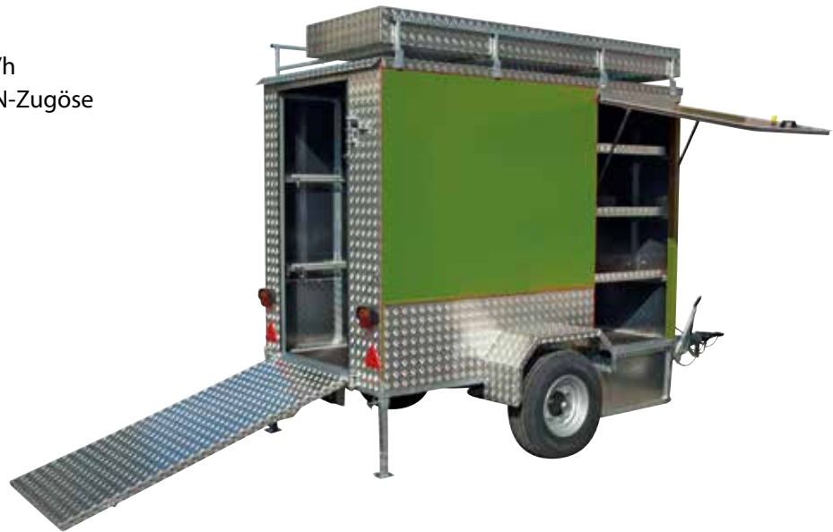
Heckrampe für bequemen und sicheren Verlad. Auf dem Dach eine optionale Werkzeugkiste
