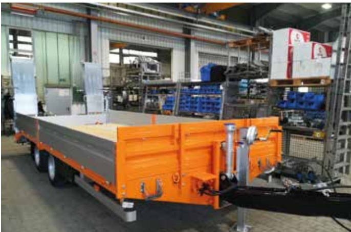
Tiefbauamt Wattwil Typ TUE 134 ZSR: Der Tandem-Tieflader ist hier in der Endmontage. 15 t GG, u.a. Faltrampen
