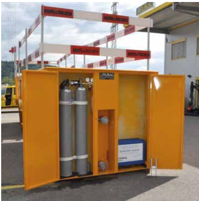
Zwei integrierte Schränke für Gasflaschen und Zubehör
