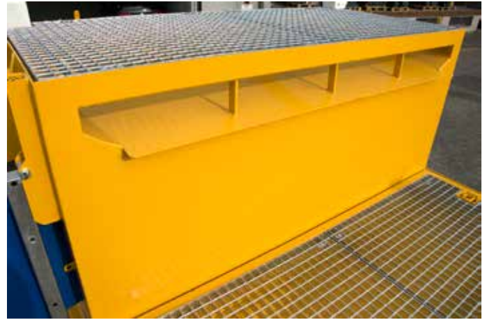
Das Wasser vom Standpodest wird über einen Überlaufkanal ins Neutralisationsbecken geleitet
