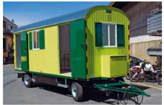
Einer von Tausend: Gefertigt und lackiert nach Wunsch der Firma Käppeli Bauunternehmung wurde dieser Bauwagen mit 6 Tonnen Gesamtgewicht. Zur Ausrüstung gehört ein 6 Meter langer Lattenkasten.
