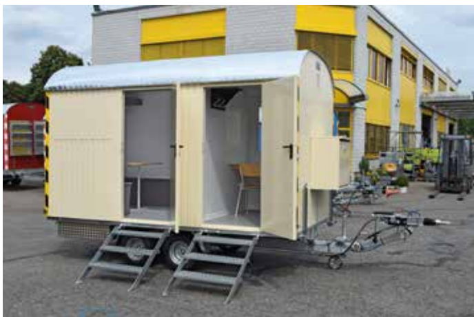
Laurent Membrez SA, Aclens type AT400/EB : avec essieux tandem, deux compartiments bureau / équipe avec chauffage à gaz et kit solaire 230 V
