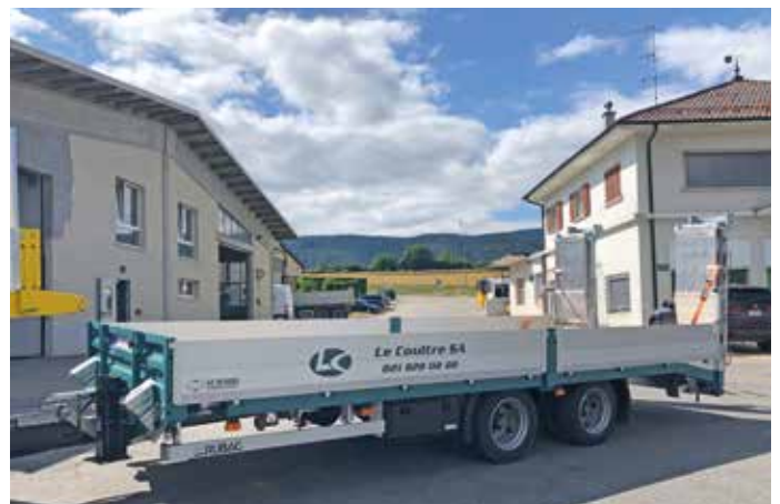
Le Coultre SA, Gimel type TUE 134 ZSR: poids total 15 t, pont 6.25 m avec pente et verrouillage de container.
