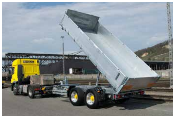
André Züger, Altendorf type DK 190 AR : remorque basculante des 3 côtés, poids total 19 t. Pont monobloc en HARDOX de 5 mm, essieux pour vitesse rapide, ridelles en aluminium, rampes, suspension pneumatique et fond spécial
