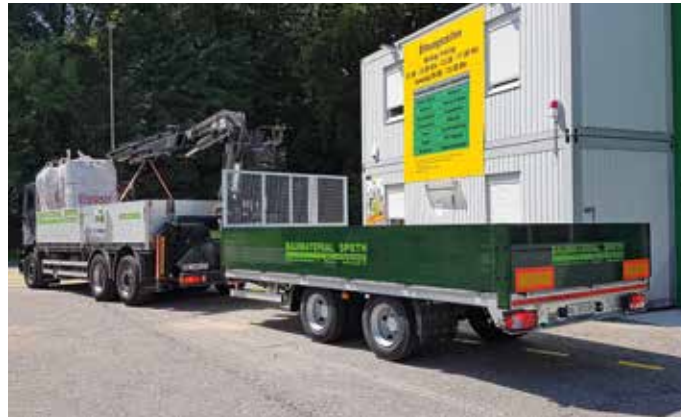
Baumaterial Späth, Riehen type LTP 160 Z : Poids total 17 t, y compris le plancher en aluminium et une grille sur la paroi frontale. En couleur client.
