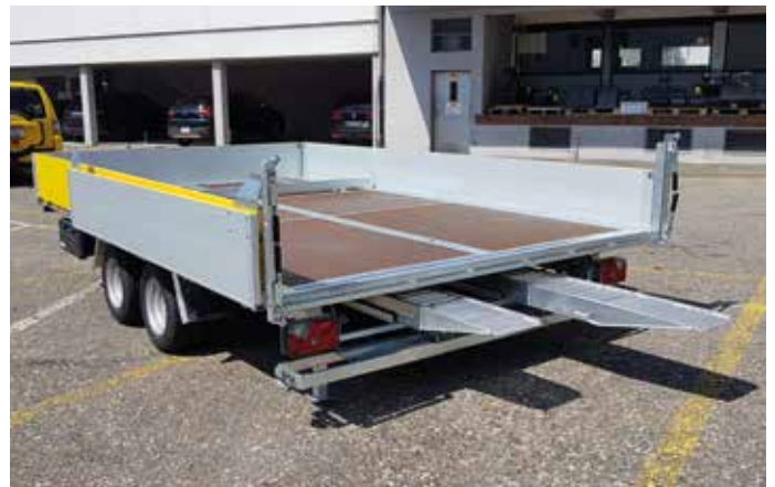
Série UE avec des ridelles basses en alu et des rampes optionnelles
