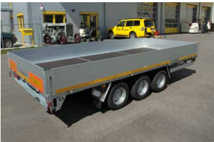
Darnutzer, Sils im Domleschg type UET 574520 : remorque-plateau à 3 essieux pour le transport de groupes électrogènes et machines de chantier.
