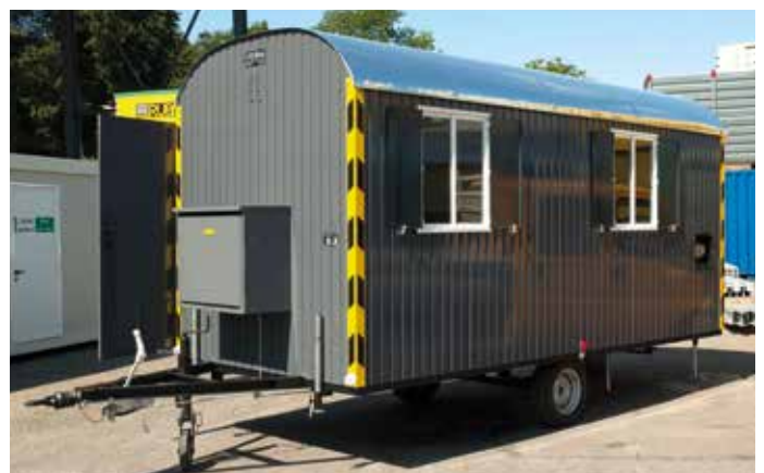
LBG, Couvet type A500 : la roulotte à un essieu la plus longue (5 m). En gris ardoise. Armoire à bouteilles de gaz 2 x 11 kg pour le chauffage
