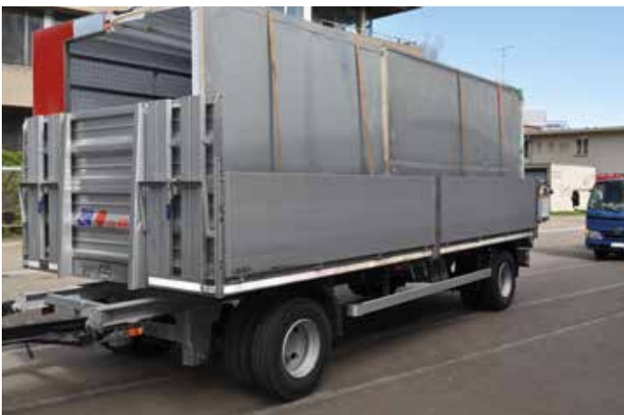
Norline, Glattbrugg type ZTA 180 Z : Plancher du pont en acier HARDOX. Support pour 8 montants poteaux enfichables sur paroi frontale extérieure. En fonction pour des transports de matériaux.
