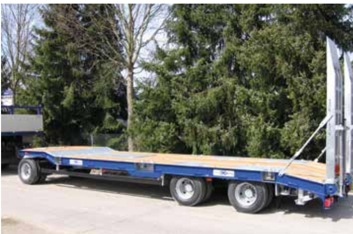
Photo d'usine type DBTAG : remorque à 3 essieux pour le transport de poids lourds, charge utile jusqu'à 24 t
