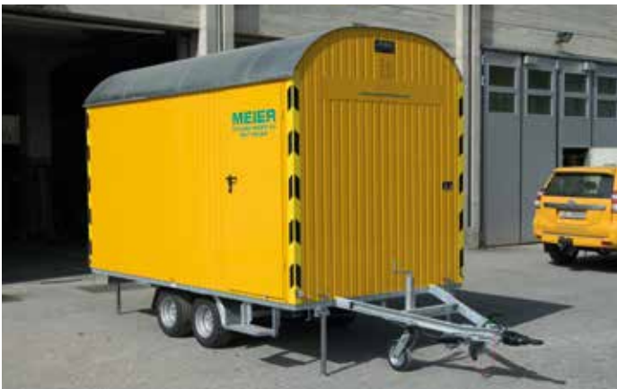
Meier AG, Wettingen type AT400/EW : en version standard avec deux compartiments pour équipe et matériel.
