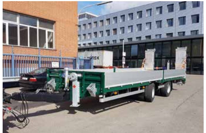
Denogent SA, Lausanne type TUE 210 ZSR : Equipé d'un essieu directeur. Cette remorque tandem a également une pente arrière. Le pont de 7,5 m de long a été réduit à 880 mm de hauteur (ainsi que d'autres modifications spéciales)
