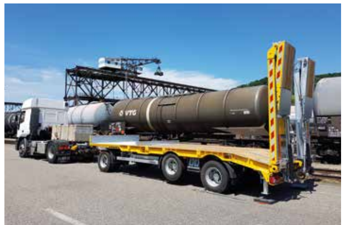
Leonhard Weiss, Regensdorf type DTPA 300 ZSR : cette remorque à 3 essieux est en service pour le transport de machines lourdes et containers.
