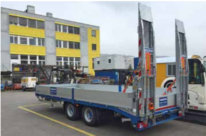
Hubschmid Logistik, Nesselbach type TUE 160 ZSR: Pont rallongé à 6.25 m et cassé à l'arrière pour réduire le coin d'inclinaison. Ridelles en alu, suspension pneumatique, verrouillage de container etc.
