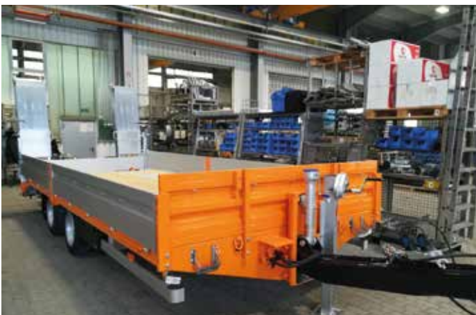
Génie civil Wattwil type TUE 134 ZSR: la remorque tandem 15 t au montage final. Avec rampes pliables.
