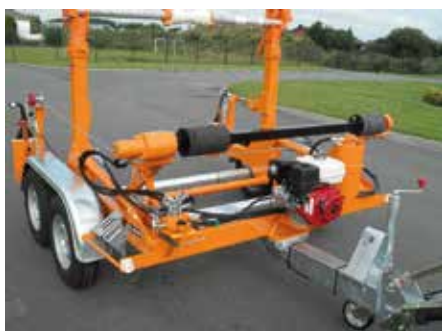
Entraînement hydraulique du tambour
