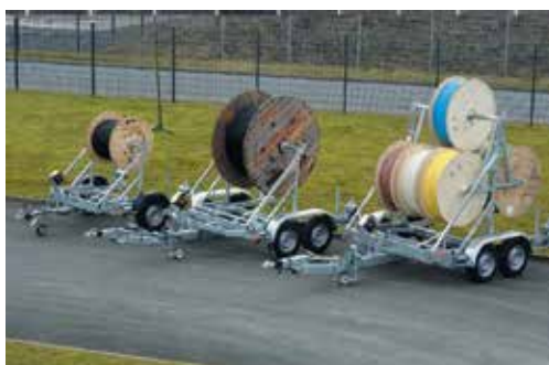
Type K1000, K1500 et K2000, la dernière avec châssis de transport pour micro-enrouleurs
