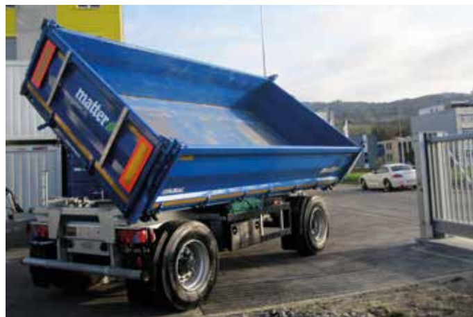
Matter, Buchs type ZDK180 : Plancher du pont et ridelles en acier spécial HARDOX. Est utilisée pour le transport de gravier.
