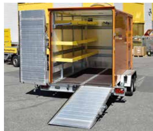
Double porte / double rampe pour le déchargement sûr des machines lourdes
