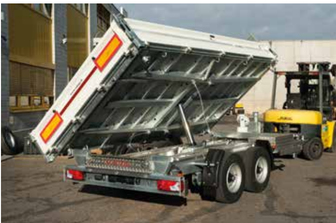
HP Tschirren Bau AG, Buchs type DK 105 AR : benne basculante tandem à trois côtés. Avec pompe électrohydraulique, rampes et renfort frontal
