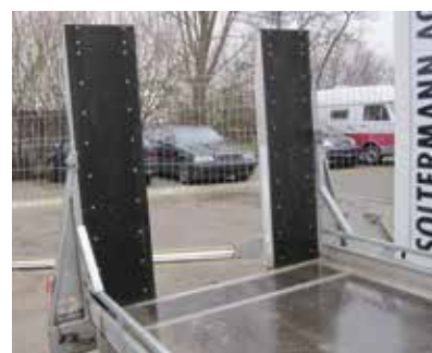
Manutention sûre des rouleaux : Les rampes sont recouvertes de caoutchouc (sur demande)
