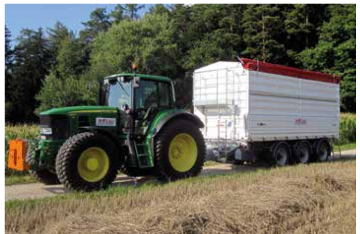
MBS, Neerach type TDK-S 270 AR : remorque tridem en service pour des travaux de construction et d'agriculture.
