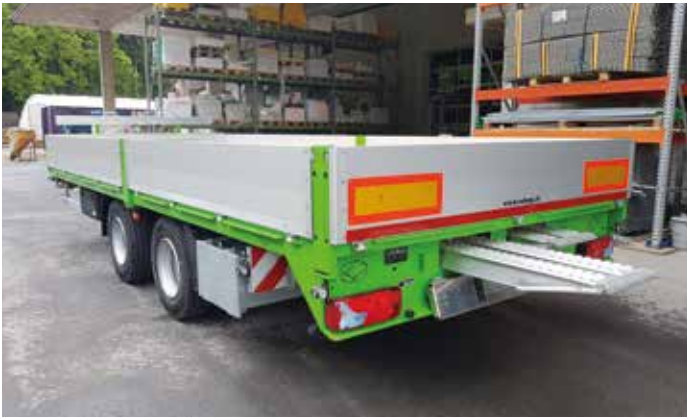
Häller Bau AG, Sempach type TUE 190 ZAR avec rampes coulissantes sous le plancher, bandes de protection du vérin de chariot élévateur et de nombreux autres extras tels que de nombreuses cassettes de chandelier et options d'arrimage.
