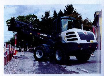
catégorie IV EU resp. Tier 4 Final. Selon souhait du client, 4 vitesses sont possibles avec une vitesse maximale de 36 km/h.
