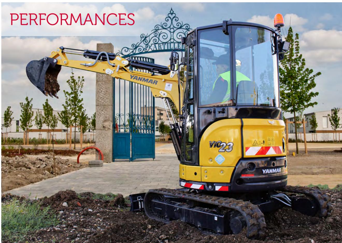
La ViO23-6 offre des performances exceptionnelles pour un engin de sa catégorie. Sa profondeur de fouille de 2450/2655 mm\* et ses forces de fouille de 17,5 kN (godet) et 13,1/10,6 kN\* lui permettent de travailler rapidement et efficacement même dans les conditions les plus difficiles.
