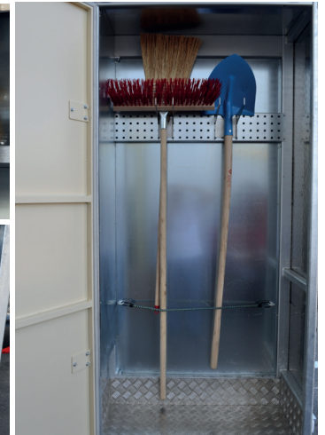
Bien conçus, disponibles et sûrs : plusieurs cuves pour bidons, tableau magnétique pour les plans de construction et plus encore. La photo à droite montre le compartiment avant droit, accessible par le trottoir et équipé de supports à outils. Sol en tôle d'aluminium strié.
