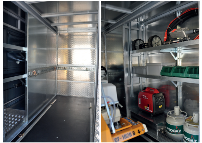
Sol en plaques sérigraphiées résistantes et rails de fixation intégrés. Vaste espace sur les étagères réglables en hauteur.
