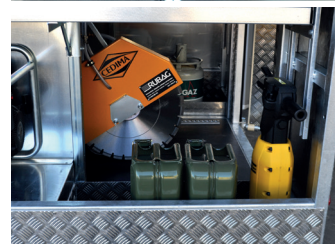
Bien conçus, disponibles et sûrs : plusieurs cuves pour bidons, tableau magnétique pour les plans de construction et plus encore. La photo à droite montre le compartiment avant droit, accessible par le trottoir et équipé de supports à outils. Sol en tôle d'aluminium strié.
