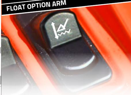
Le bras du godet peut être mis en position flottante à l'aide de l'interrupteur optionnel.
