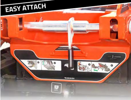
Grâce au système d'attache rapide, un dumper à chenilles RUBAG peut être transformé en dumper, mini-chargeur, bétonnière et autres. Changez, vérifiez et partez !
