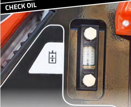
Un seul point de service pour vérifier le niveau et la température du fluide et pour faire l'appoint d'huile hydraulique.
