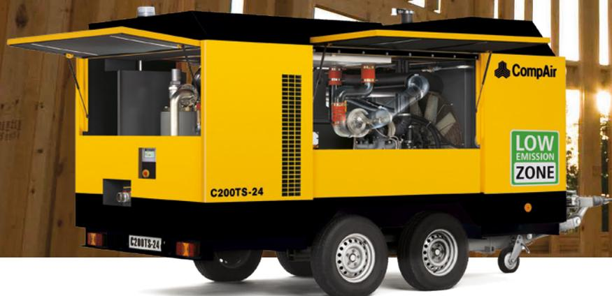
Les compresseurs TurboScrew, avec leur technologie bi-turbo unique, offrent un rendement du diesel inégalé, un poids réduit de 3 500 kg et des performances conformes à la directive européenne 97/68/CE Stage 4 final relatives aux émissions et à la préservation de l'environnement. Les nouveaux compresseurs TurboScrew sont dotés du système primé SCRT® (Selective Catalytic Reduction Technology) capable d'éliminer quasiment toutes les émissions d'oxyde d'azote des gaz d'échappement diesel.
