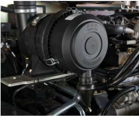
Filtration moteur optimisée par une double filtration.
