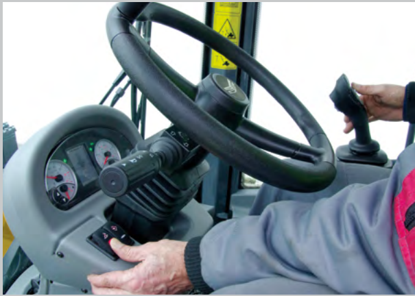
Ajustement proportionnel électrique de la performance hydraulique des 3e et 4e circuits.
