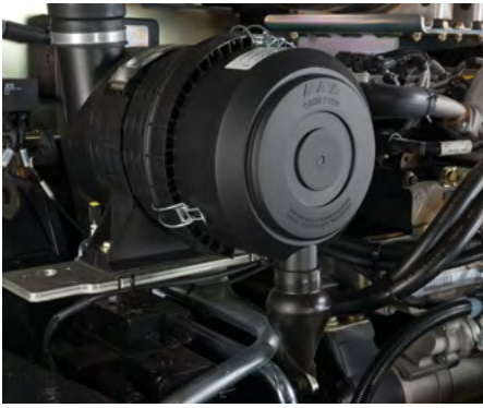
Filtration moteur optimisée par une double filtration.
