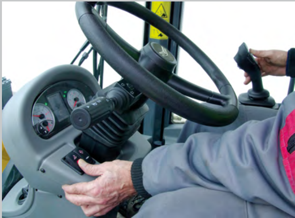
Ajustement proportionnel électrique de la performance hydraulique des 3 e et 4 e circuits.
