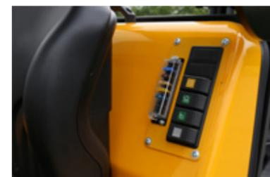
Les fusibles sont faciles à vérifier et à remplacer.
