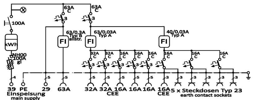
**RUBAG** - Anschlussverteilerschrank im Gehäuse aus verzinktem Stahlblech, pulverbeschichtet RAL 1021, bestückt mit:
