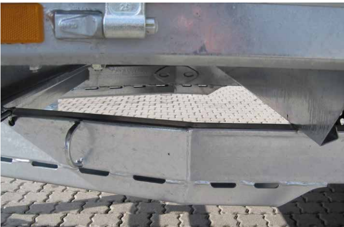
Serien-Detail: Hohlprofil-Hauptrahmen mit Unterzug im Übergang zur V-Deichsel
