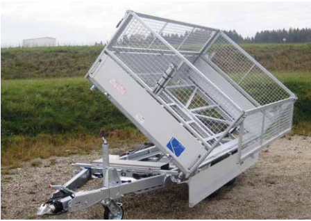
Sonderausstattung: Welldrahtgitteraufbau 600 bzw. 1.000 mm hoch abklappbar (Bordwandverbinder) und pendelbar
