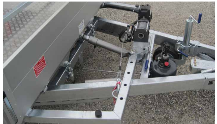
Sonderausstattung: Elektr. Seilwinde mit Kabel und/oder Funksteuerung (Stromversorgung vom Zugfzg. – NATO-Stecker od. Batterieanlage Anhänger) Seilumlenkung auf Serien-Windenbock ALU-Tränenblechboden zusätzlich auf Siebdruck-Platte Maschinen-Anschlagschiene verstellbar
