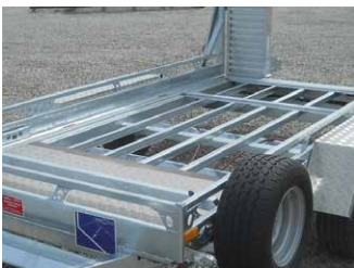
Serien-Detail: Längs-Unterzüge für hohe Punktlasten
