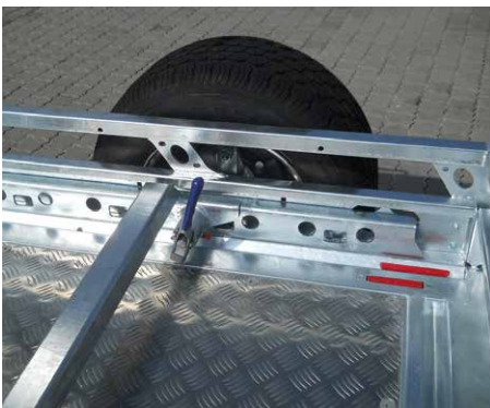
Sonderausstattung: Maschinenanschlagschiene verstellbar
