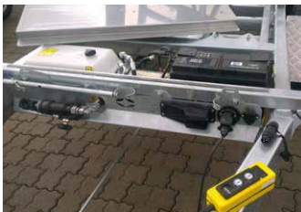
Sonderausstattung: Elektr.hydr. Pumpenaggregat, Batterieanlage, Not-Handpumpe, Kabel-Fernbedienung und Steckdose Ladegerät
