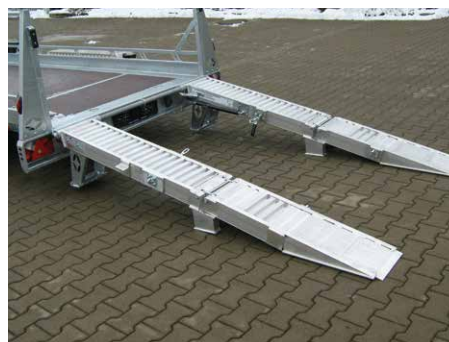
Sonderausstattung: ALTEC-ALU-Rampen verlängert, klapp- und faltbar (L x B ca. 2.410 x 310 mm)
