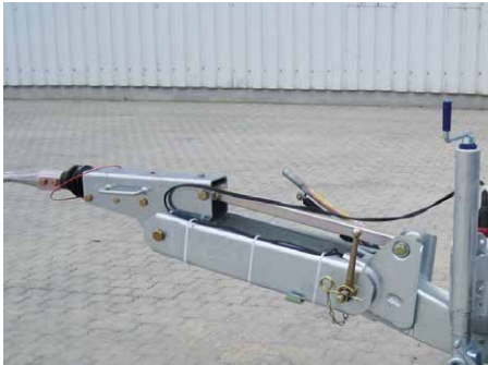
Sonderausstattung: Höhenverstellbare Zugdeichsel (Zwischenstück 400 oder 700 mm möglich) Wechsel zwischen Kugel und 40er DIN-Öse möglich
