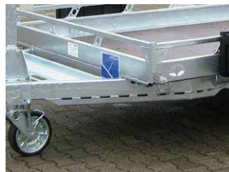
Serien-Detail: Stabiler und verwindungssteifer Hohlprofilrahmen mit Unterzug verstärkt
