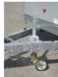
SR 60 VA Stützrad 60 mm Vollautomatisch
