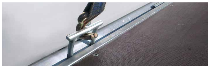
Serien-Detail: Hochziehbarer Zurrbügel (800 daN) in V-Sicke
