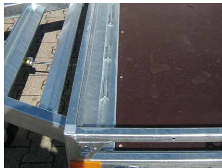
Sonderausstattung: Brückenprofil stirnseitig mit integrierter V-Sicke und hochziehbaren Zurrbügeln – 800 daN (wie seitlich)
