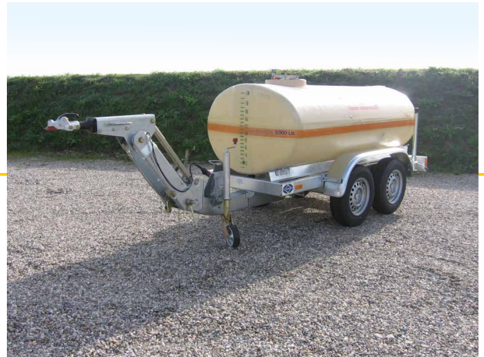
Abb.: FG 3500 HV – zul.GG. 3.500 kg Sonderausstattung: Höhenverstellbare Auflaufeinrichtung verstärktes 70er Stützrad Heckstützen- Klemmschelle 2000 ltr. Chemo-Fass
