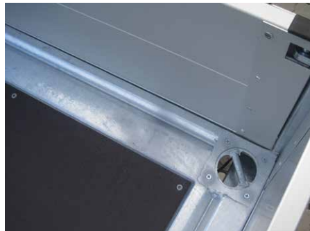
Sonderausstattung: Drehbarer Zurrstab in den Ecken (1.250 daN)
