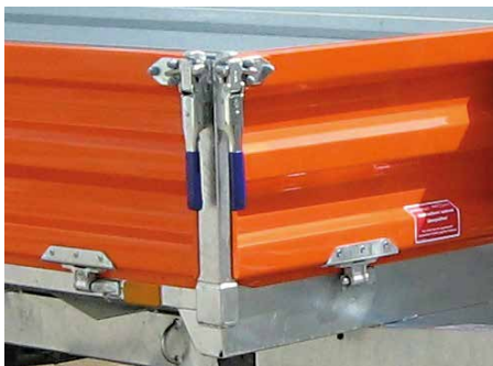
Sonderausstattung: Pendelverschluss 664 – aufgesetzt Stahlbordwandaufbau verzinkt + lackiert
