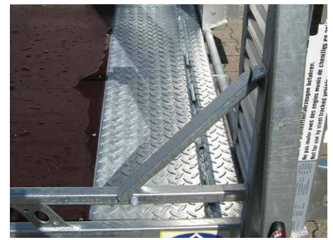
Sonderausstattung: Brückenprofil heckseitig mit integrierter V-Sicke und hochziehbaren Zurrbügeln – 800 daN (wie seitlich)
