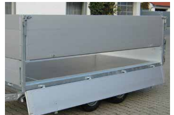
Sonderausstattung: ALU-Aufsatzbordwände 600 mm hoch abklappbar (Bordwandverbinder) und pendelbar
