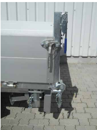
Sonderausstattung: Pendelverschluss 664 für Heckwand oben, Pendelverschluss 603 für Heckwand unten, Winkelhebelverschluss für Seitenwand
