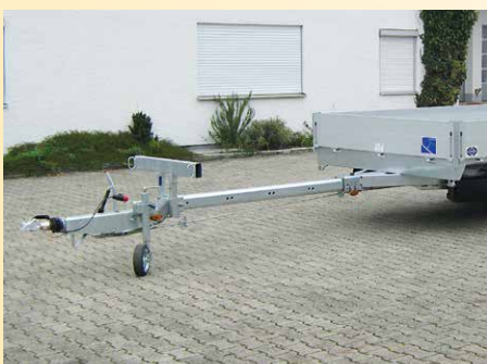
Sonderausstattung: Längenverstellbares Zugrohr Materialauflagebock vorne mittig mit Zurrösen
