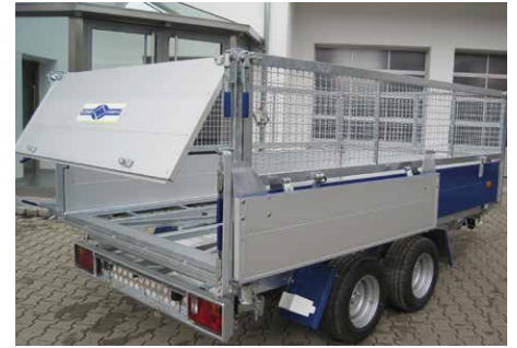
Sonderausstattung: Rückwand zusätzlich als Schwenktüre (zusätzlich zum abklappen und pendeln)
