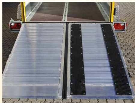
Serien-Detail: Bodenrahmen-Sicke seitlich mit hochziehbaren Zurrbügeln Sonderausstattung: Mittel-Bodenschiene mit Sicke und hochziehbaren Zurrbügeln, Gummi-Streifen-Belag (z.B. für für Walzen)
