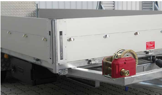
Sonderausstattung: Seilwinde (900 kg) mit Handkurbel und umsteckbarer Seilumlenkung auf Serien-Windenbock, Netzhaken an ALU-Bordwand
