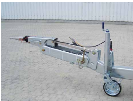
Sonderausstattung: Höhenverstellbare Zugeinrichtung (Zwischenstück 700 mm oder 400 mm möglich)
