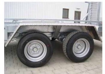
Serien-Detail: ALU-Tränenblech-Kotflügel begehbar mit Abstrebung zum Rahmen
