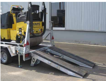
Sonderausstattung: Rampenbelag zusätzlich aus Gummi – rutschhemmend (z.B. für Walze)
