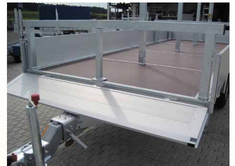
Sonderausstattung: Bodenhülsen mit Steckungen und Langmaterial-Auflageböcken
