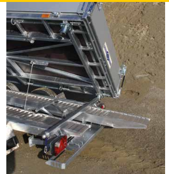
Serien-Detail: Rampenschacht unter der Brücke
