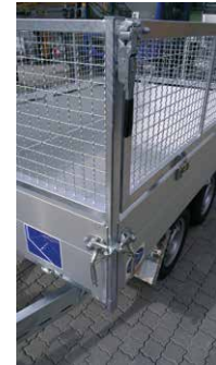
Sonderausstattung: Unten Winkelhebelverschluss – aufgesetzt, Welldraht-Gitteraufbau mit Pendelverschluss 664 oben
