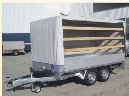
Sonderausstattung: Hochplane mit verz. Gestell und Stecklatten, Planenfarbe und Verschlüsse nach Kundenwunsch
