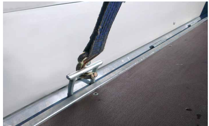
Serien-Detail: Hochziehbarer Zurrbügel (800 daN) in V-Sicke
