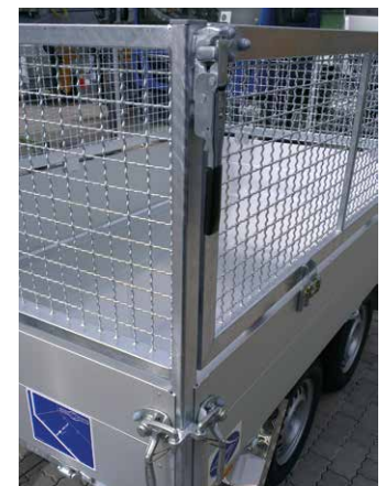
Sonderausstattung: Winkelhebelverschlüsse an Grundbordwand Welldrahtgitteraufbau mit Pendelverschlüssen 664
