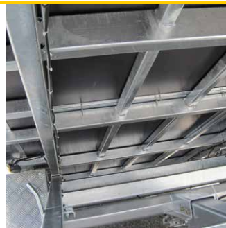
Serien-Detail: Kippbrücke mit Hohlprofilträger und zusätzlichen Unterzügen
