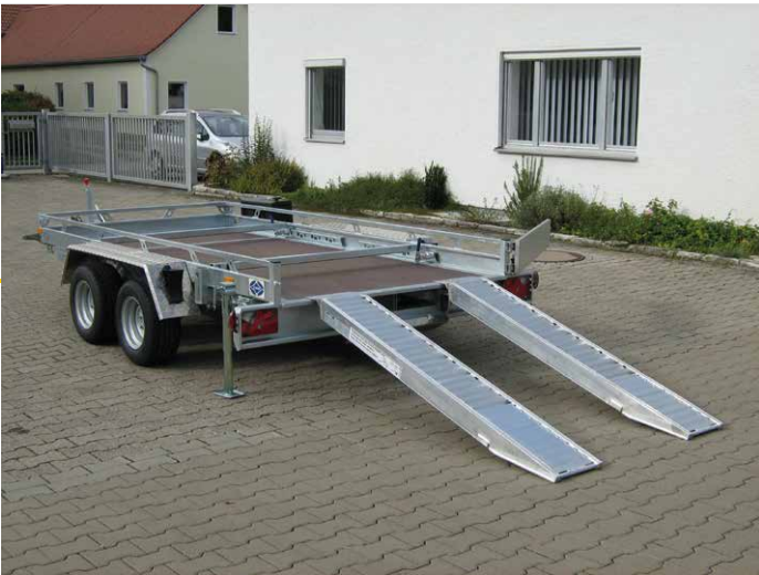
Abb.: GTA 350 LS – Schieberampen zul.GG 3.500 kg Ladefläche 3.500 x 1.700 mm Bereifung 225/55/R12 – LH ca. 520 mm ALTEC-ALU-Einschubrampen 1.960 x 310 mm Rückwand als 1-flügelige Türe Sonderausstattung: verstellbare Maschinen-Anschlagschiene
