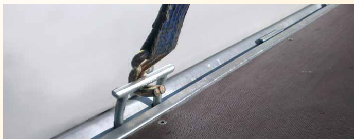
Serien-Detail: Hochziehbarer Zurrbügel (800 daN) in V-Sicke
