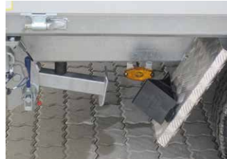
Serien-Detail: Heckstütze klappbar mit Federriegel für Rampenbetrieb
