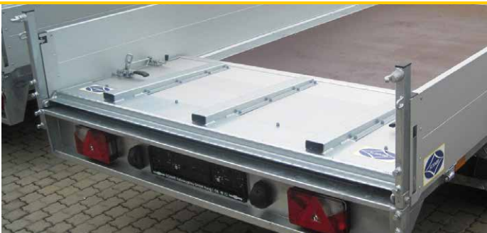
Serien-Detail: Überfahrklappe ca. 940 mm hoch, heckseitig umlegbar und arretierbar (für Leerfahrt)
