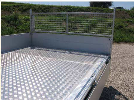
Sonderausstattung: ALU-Tränenblechboden auf Siebdruckboden, Stirnwandhöhung / Lastenschutzgitter verzinkt
