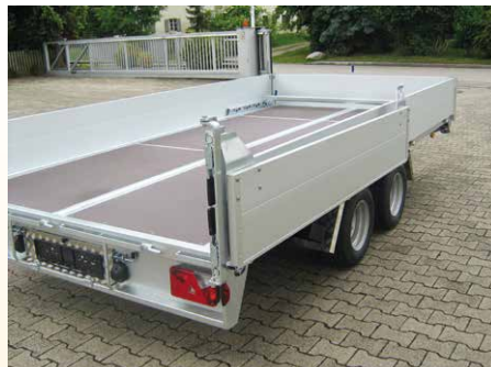
Sonderausstattung: Heckwand zusätzlich als Schwenktüre (1-flügelig 270°), Rampenschacht, Mittel-Längs-Sicke mit hochziehbaren Zurrbügeln
