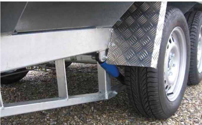
Serien-Detail: Hauptrahmen – Unterzug für lange Brücken
