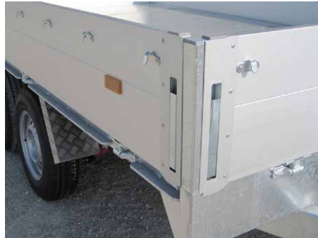
Serien-Detail: Serien-Riegelverschluss innenliegend Sonderausstattung: Netzhaken aufgesetzt
