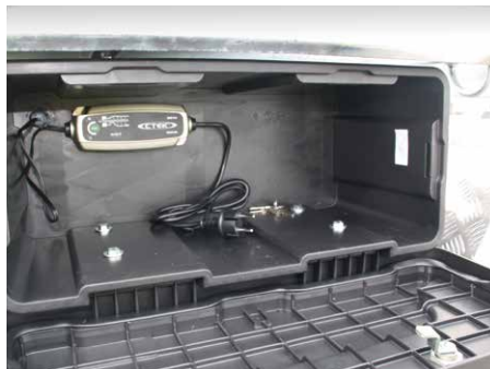
Sonderausstattung: C-TEC-Ladegerät in Staukasten (zum Laden der Batterie direkt an eine Netzdose anzustecken)
