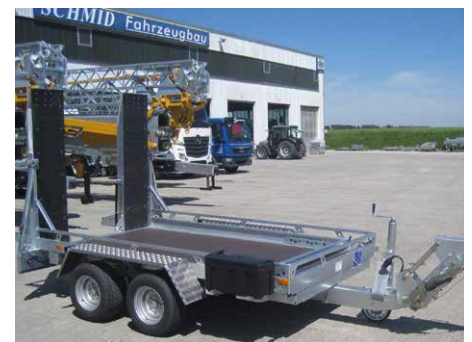
GTA 350 LK – zul.GG 3.500 kg Sonderausstattung: Höhenverstellbare Zugeinrichtung Gummi-Rampenbelag auf ALU-Rampe, Kunststoff-Stau- kasten seitlich
