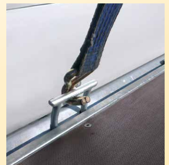
Detail: Hochziehbarer Zurrbügel (800 daN) in V-Sicke
