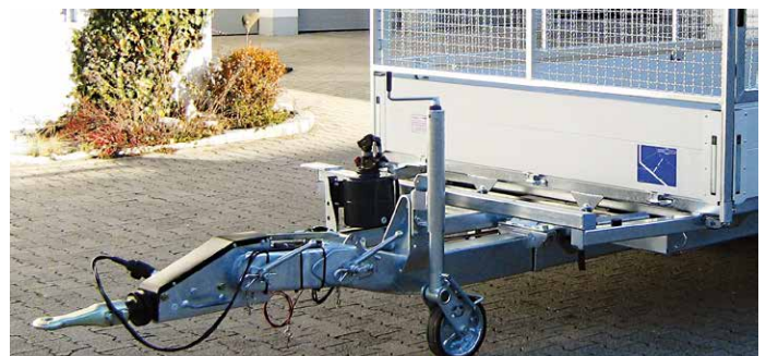
Sonderausstattung: Höhenverstellbare Zugeinrichtung mit 40 mm DIN-Zugöse (wechselweise Kugelkupplung), mit verstärktem 70er Stützrad, Welldraht-Gitteraufbau 600 mm hoch, verzinkt
