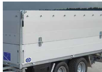
Sonderausstattung: ALU-Aufsatzbordwände 600 mm hoch abklappbar (Bordwandverbinder) und pendelbar
