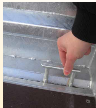
Serien-Detail: Hochziehbarer Zurrbügel in Bodenrahmen-V-Sicke (800 daN)
