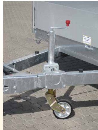
SR 60 VA Stützrad 60 mm Vollautomatisch
