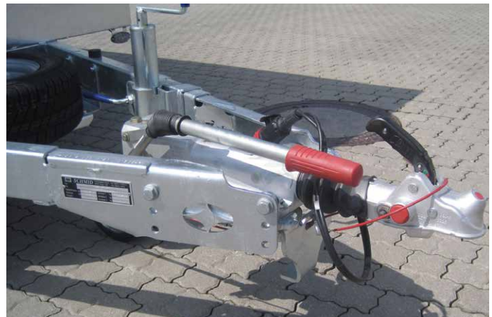
Serien-Detail: Einbindung der Zugeinrichtung (Auflaufeinrichtung) in V-Deichsel - höhenverstellbar montierbar
