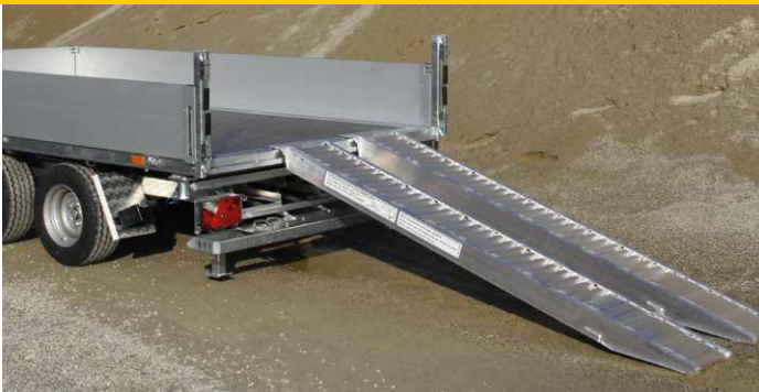
Sonderausstattung: ALTEC-ALU-Anlegerampen, Tragkraft 2,8 to./ Paar, L x B ca. 2.410 x 310 mm
