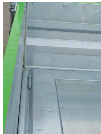
Sonderausstattung: Zusatzboden aus 2 mm Stahlblech verzinkt (auf Holzbohlen geklebt, geschraubt, versiegelt)
