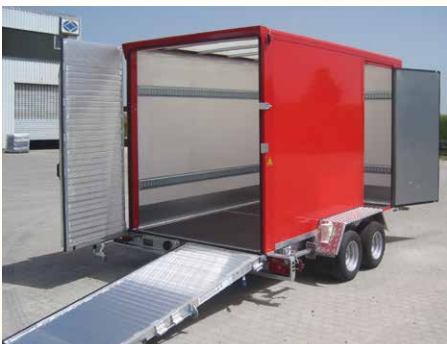
Serien-Detail: ALTEC-Rampe / Türe – Kombination Sonderausstattung: Seitentüre (Öffnung ca. 950 x 1.900 mm)
