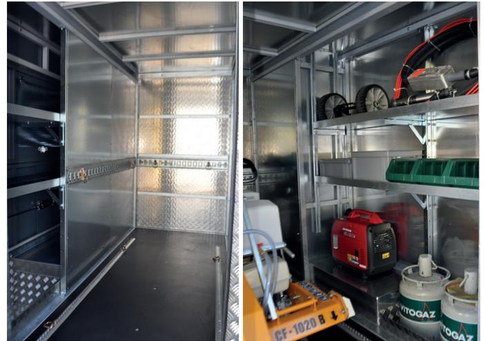
Boden mit widerstandsfähiger Siebdruckplatte und integrierten Befestigungsschienen. Rechts: Viel Stauraum auf den höhenverstellbaren Regalen.
