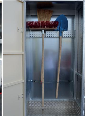
Durchdacht, einsatzbereit und sicher: Mehrere Wannen für Kanister, Magnettafel für Baupläne und vieles mehr. Das Bild rechts zeigt das Abteil rechts vorne, das von der Trottoirseite her bedient wird und mit Werkzeughaltern ausgestattet ist. Boden aus Alu-Riffelblech.
