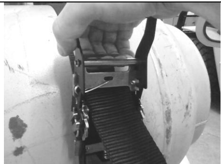
2. Schritt 1 weiterführen und die Spannvorrichtung nach oben gleichzeitig schieben, bis sie die Stahlflasche berührt.
