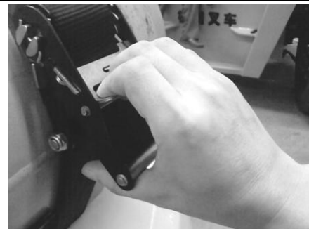
1. Spannvorrichtung mit rechter Hand festhalten. Verriegelung mit Zeige-, Mittel- und Ringfinger herausziehen.
