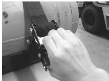
3. Die Verriegelung außerhalb halten und die gesamte Spannvorrichtung nach unten ziehen.
