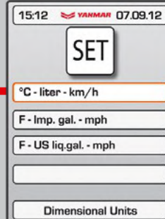
Setup-Menü für die Einstellung der Einheiten wie Geschwindigkeit, Temperatur und weitere Möglichkeiten.
