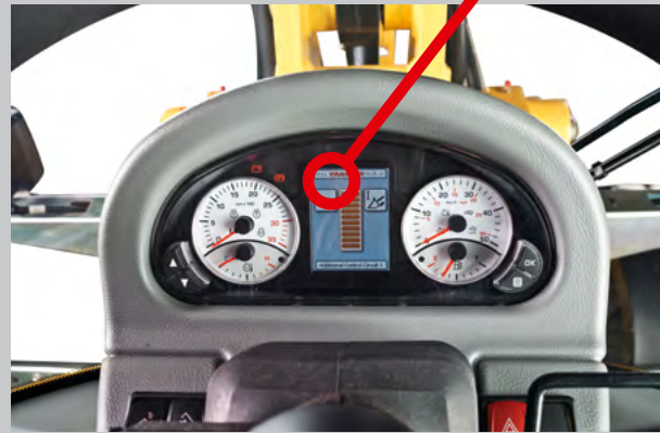
Setup-Menü für die Einstellung der Einheiten wie Geschwindigkeit, Temperatur und weitere Möglichkeiten.
