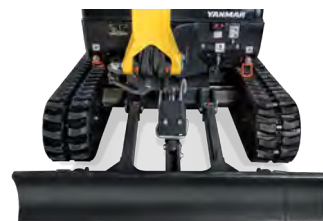
Ausgefahrener Unterwagen: 1320 mm
