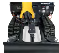
Eingefahrener Unterwagen: 980 mm
