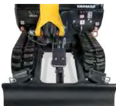
Eingefahrener Unterwagen: 980 mm
