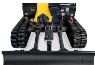
Ausgefahrener Unterwagen: 1170 mm
