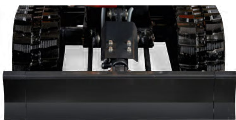
Ausgefahrener Unterwagen 840 mm - Mehr Standfestigkeit
