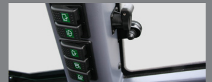
Zusammengefasste Schalterleiste, Steckdose mit Dauerstrom
